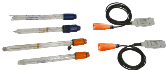
Кабель преобразователя с различными электродами
