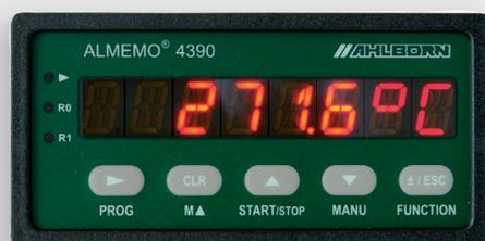
**Прецизионный измерительный прибор ALMEMO® в панельном корпусе с функцией регистратора данных. Широкий выбор функций для всех областей применения. Улучшенная точность, высокая скорость измерений, 1 измерительных вход, 2 встроенных реле предельных значений. Опция: двойной аналоговый выход.**
