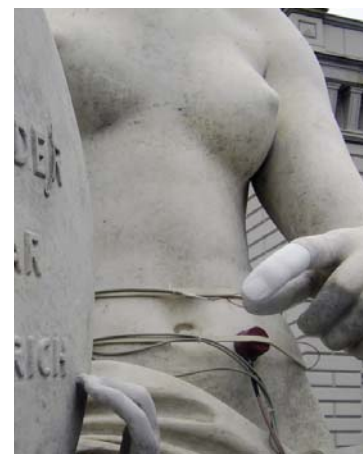
Измерение температуры поверхности с помощью NTC датчика температуры FN 0001. Датчик влажности FHA 646 R в специальном корпусе для микроклиматических измерений.
