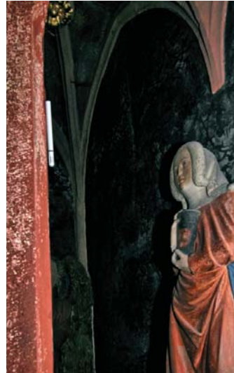
Датчик влажности и температуры на границе помещений.
