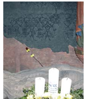
Датчик температуры поверхности, на настенной фреске.
