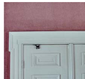
Фотоячейка отражения, для регистрации положения двери. Фирма Fiessler.
